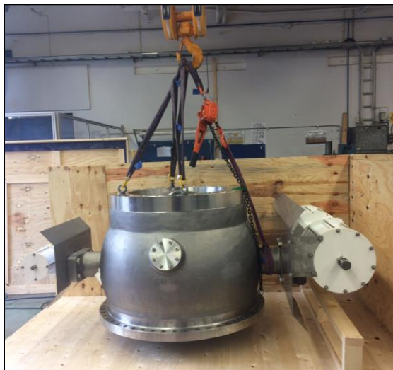
Abbildung 2: Anheben eines NAF ProCap mit montierten Stellgliedern.
