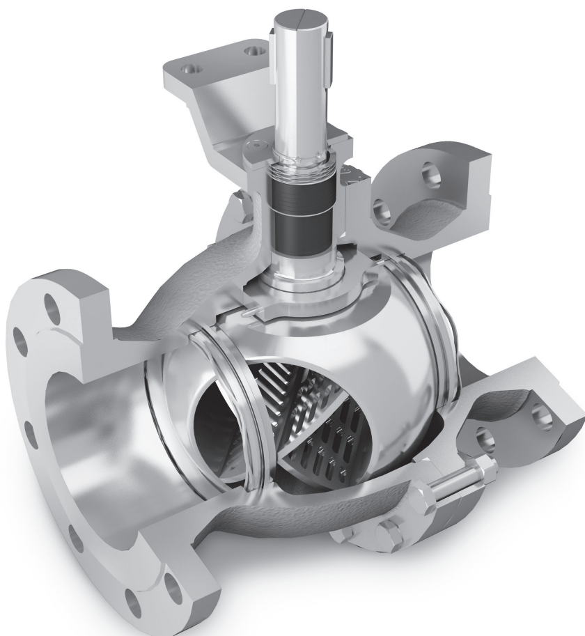
NAF Trunnball DL med Z-trim som reducerar buller och kavitation
